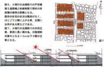
図6. 6階建ての法規制での戸別建物と連絡橋と斜線制限で現存する店舗の確保の困難となる。
